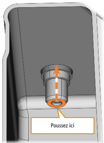
FIG. 86 – EXTRAIRE LE COUPLAGE HORS DU RÉSERVOIR
