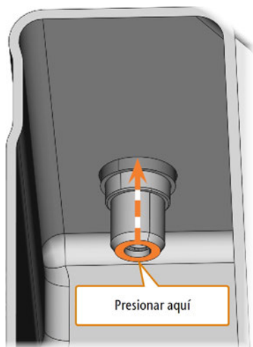
FIG. 86 – EMPUJAR EL ENGANCHE FUERA DEL DEPÓSITO
