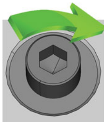
FIG. 41 – DÉVISSER LA VIS À LA POSITION SOUHAITÉE
