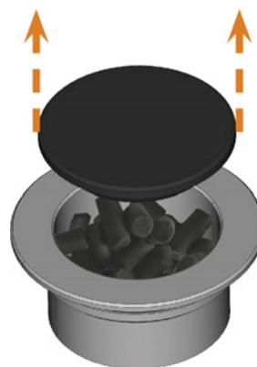
FIG. 83 – OUVREZ LE FILTRE À CHARBON
