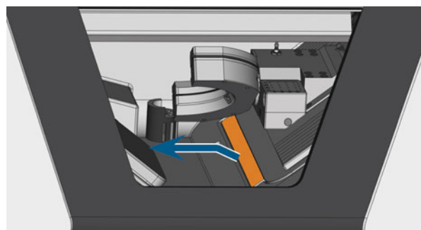
FIG. 64 – DÉMONTER LA BANDE DE PROTECTION (MARQUÉE EN ORANGE)
