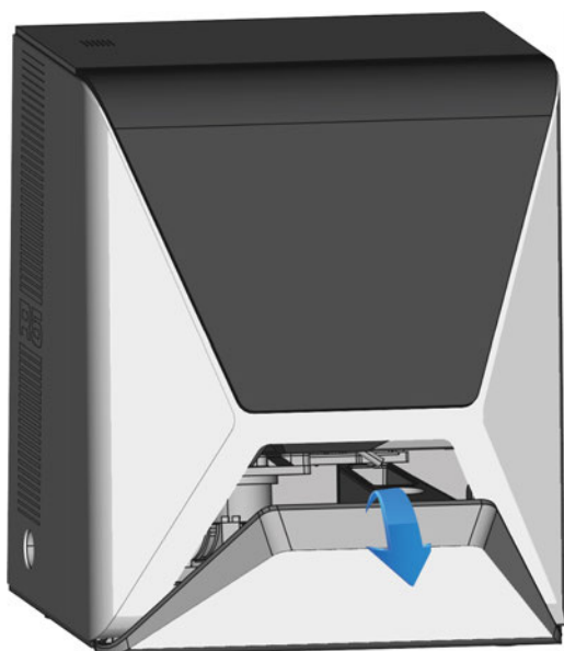
FIG. 60 – TIRARE MANUALMENTE VERSO IL BASSO L'ALETTA DEL COMPARTIMENTO MULTIFUNZIONE
