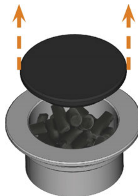
FIG. 83 – ABRIR EL FILTRO DE CARBÓN
