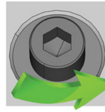
FIG. 44 – APRETAR EL TORNILLO PARA INMOVILIZAR EL BLOQUE
