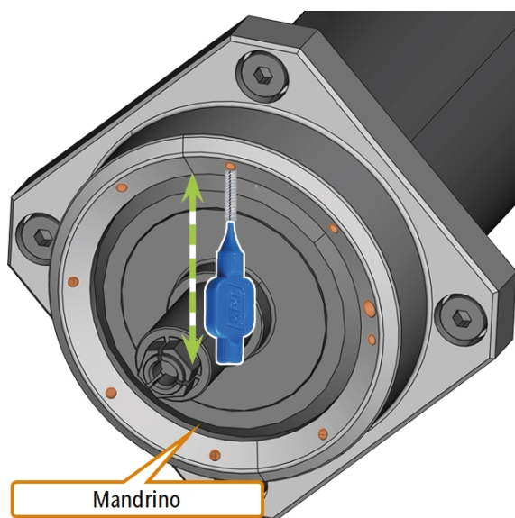
FIG. 78 – PULIZIA DELLA PIASTRA DELL'UGELLO; UGELLI CONTRASSEGNA TI IN ARANCIONE
