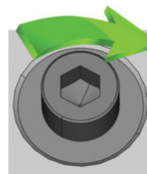
Abb. 41 – DIE SCHRAUBE AN DER GEWÜNSCHTEN POSITION LÖSEN
