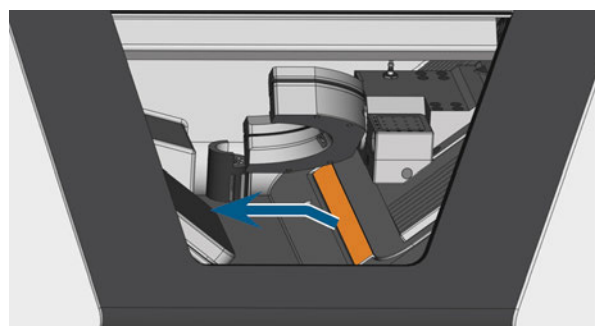
FIG. 64 – RETIRADA DE LA BANDA PROTECTORA (MARCADO EN NARANJA)
