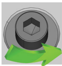
FIG. 44 – VISSER LA VIS POUR IMMOBILISER LE BLOC
